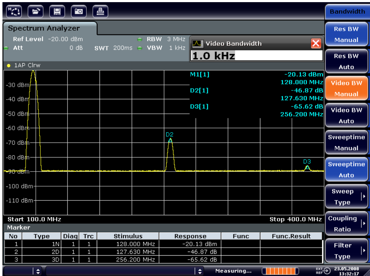
图 6-11: 在谐波测量过程中，通过降低视频带宽抑制噪声
